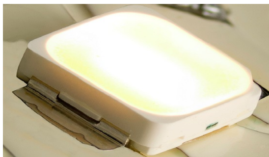
Фотография светодиода серии XLamp MX-3
